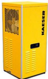
El Secador Refrigerativo para Alta Temperatura (HTRD) cuenta con un compacto diseño que requiere poco espacio y permite una fácil instalación. Está diseñado específicamente para su uso con Compresores de Pistón 5-25 cv. Incluye Post-Enfriador, Unidad de Refrigeración, Separador de Filtrado y un Drenaje de Condensado, permitiendo eliminar con ello la humedad y los contaminantes del aire proporcionando aire limpio y seco adecuado para la mayoría de las herramientas de taller.
