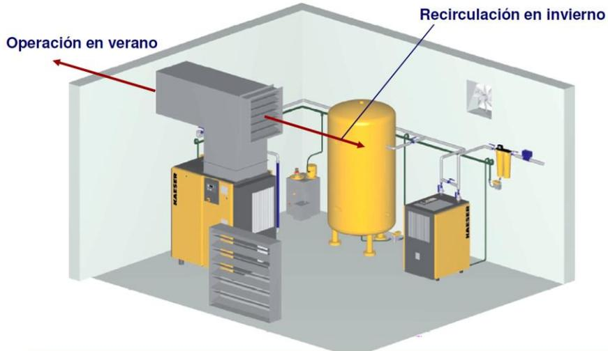
Cuando la temperatura exterior es menor a **+3 °C**, el aire caliente puede mezclarse con el aire de admisión frío para evitar la congelación.
